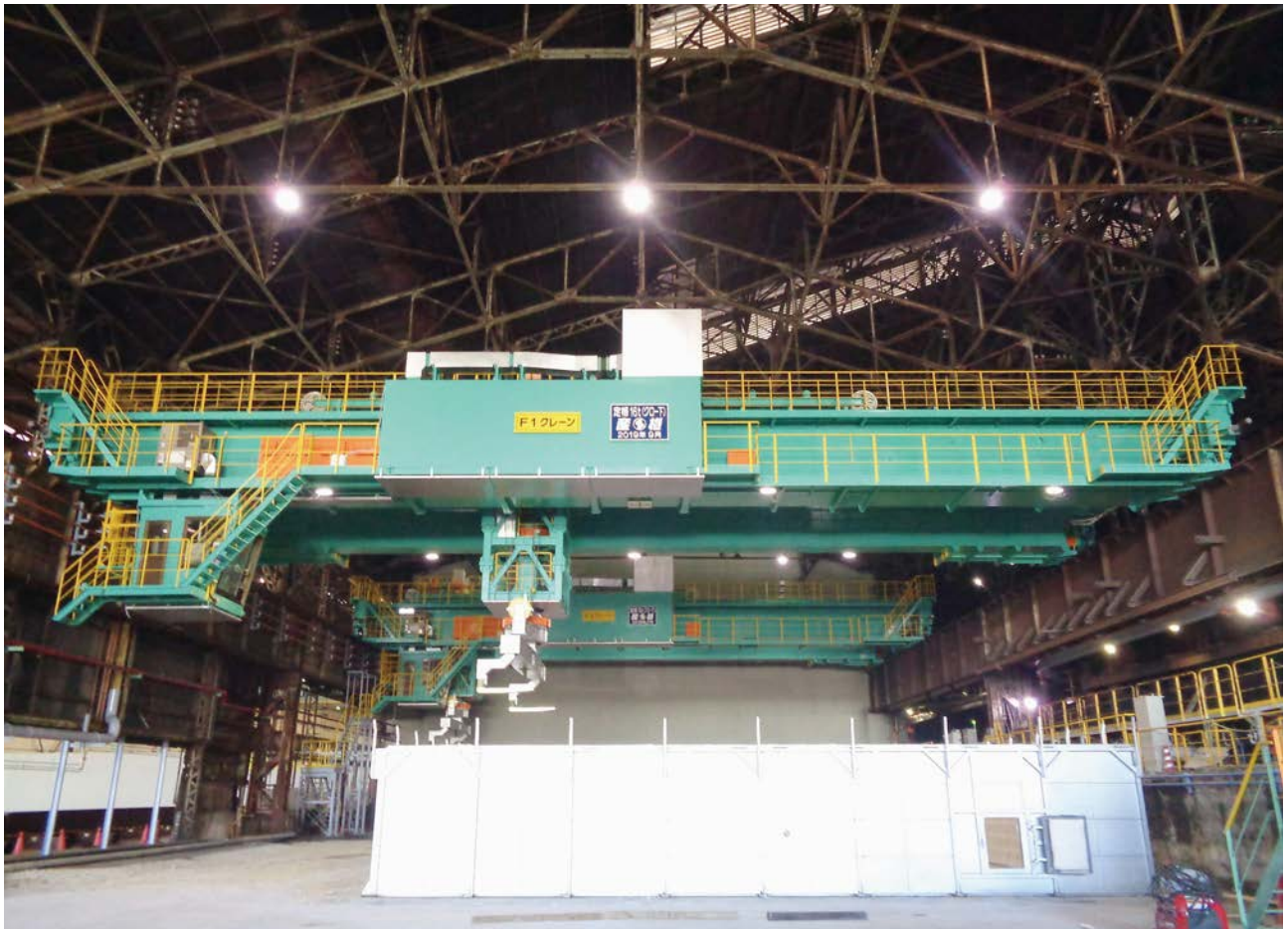
製鉄所向 クロー下 16t マスト式天井クレーン
